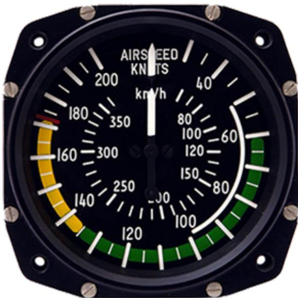
Osservando il display dell'indicatore di velocità, quale sarebbe la velocità di stallo con i flap estesi?
