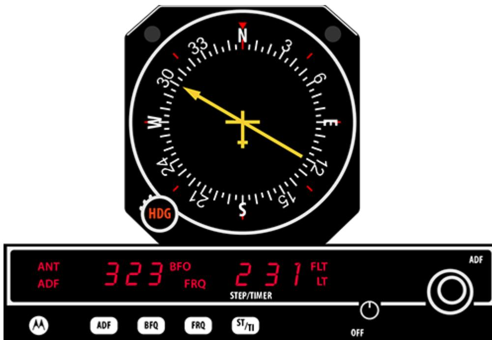
In figura si osserva il Display di un ADF a ghiera fissa e la sezione del pannello di controllo che lo riguarda. Quale tra le seguenti letture risulta corretta?
